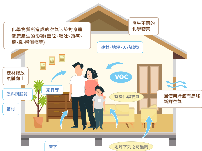
新裝潢室內完工時屋內各種建材所釋放的有害化學物質
